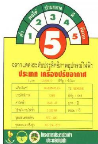
รูปที่ 1.8 : No.5 efficiency label in air conditioning unit
