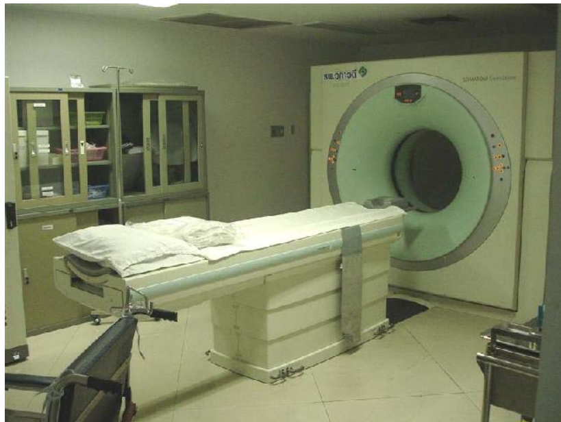
รูปที่ 2.3.6 แสดงเครื่องเอ็กซเรย์ร่วมกับระบบคอมพิวเตอร์ (X-Ray Computerized Tomography Scanner; CT scan)
